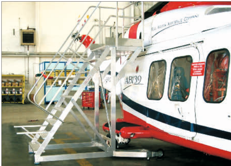
Scala a palchetto in vetroresina isolante
