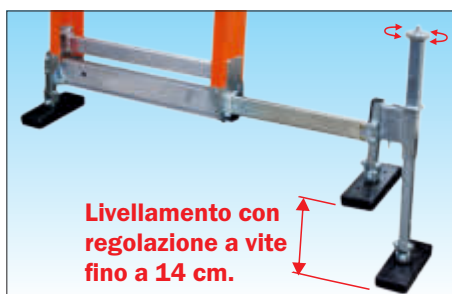
Basetta dotata di n° 1 piede livellatore in acciaio zincato con regolazione a vite e piede basculante che può essere montato e smontato all'occorrenza per colmare pendenze o dislivelli con facilità e precisione
